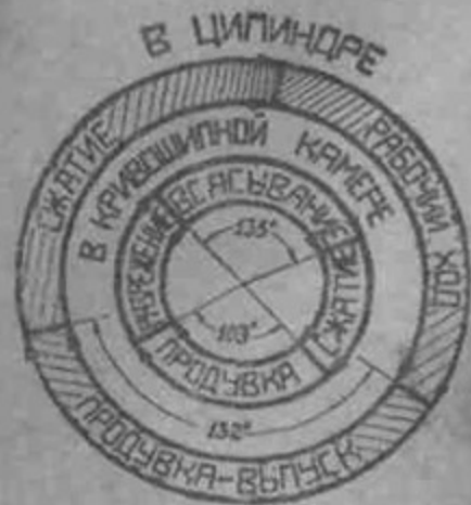
Рис. 3. Диаграмма газораспределения
